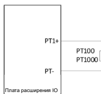
Рис. 5-25 Измерение температуры РТ100 /РТ1000с помощью платы расширения
